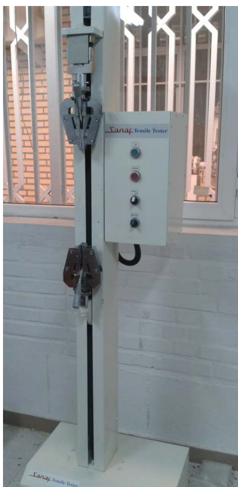
شکل ۳-۳: دستگاه تست کشش پلی‌اتیلن (Tensile)
