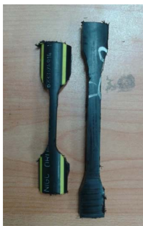
شکل ۲-۳: نمونه‌های دمبلی شکل برش داده شده از لوله‌های پلی‌اتیلن
