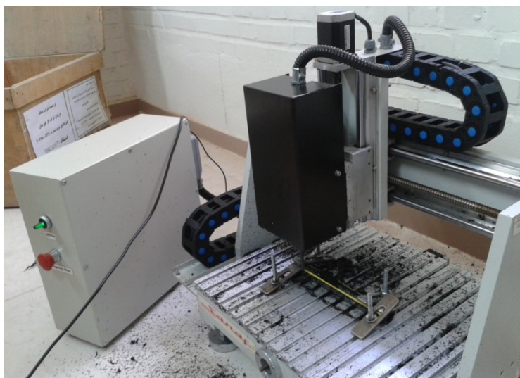
شکل ۱-۳: نمایی از دستگاه CNC راه‌اندازی شده جهت تولید نمونه‌های دمبلی شکل
