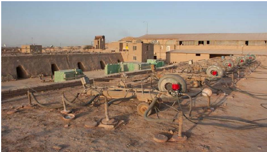
شکل ۲-۲: نمونه‌ای از بهینه کردن فرآیند پخت با استفاده از اتوماسیون کردن سوخت‌پاش‌ها (شیرها با رنگ
