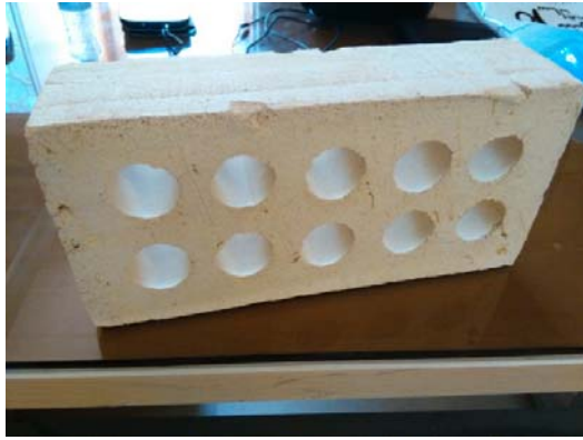
شکل ۳-۷: آجر پخته شده در کوره الکتریکی
