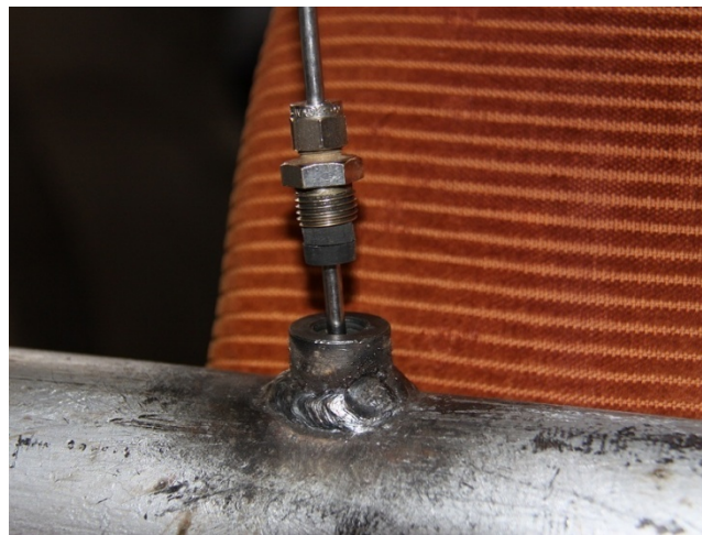
شکل ۲-۳۲: نحوه‌ی بسته شدن لوله پیتوت
