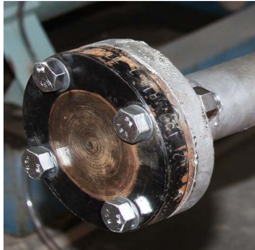
شکل ۲-۳۱: مسدود کردن ورودی دبی سنج
