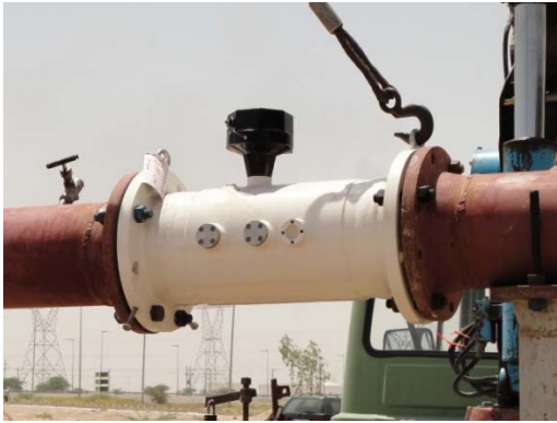
شکل ۲-۵: دبی سنج قدیمی (سمت راست) و جدید (سمت چپ) نصب شده در محل تست
