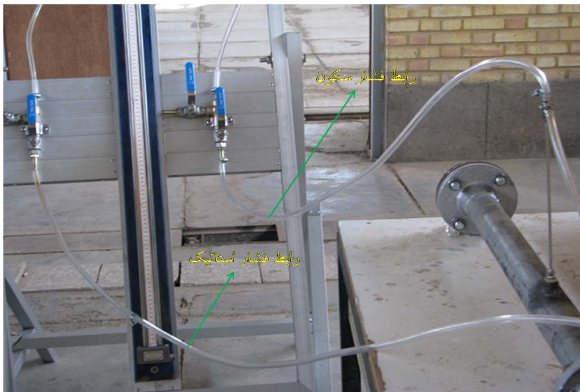
شکل ۴۴-۲: نحوه‌ی بسته شدن لوله پیتو-استاتیک به بورد مانومتر
