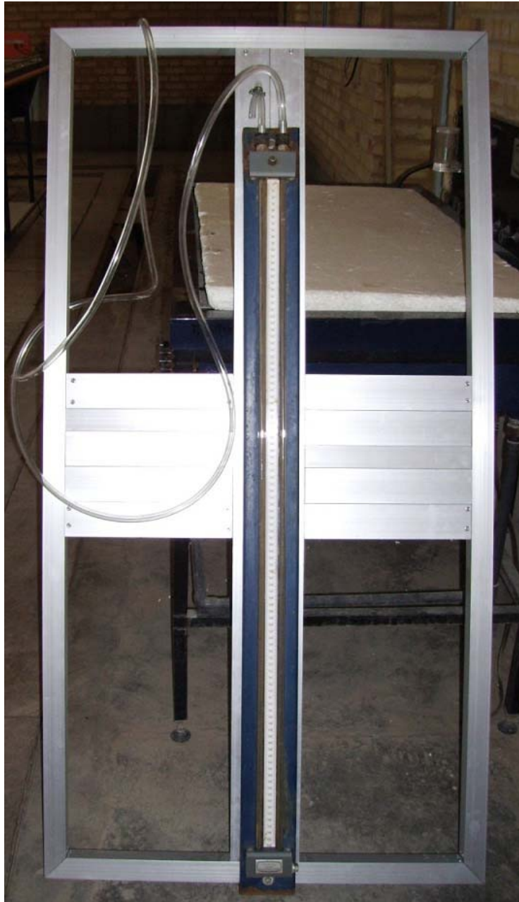
شکل ۲-۳۸: نحوه‌ی اتصال مانومتر به بورد
