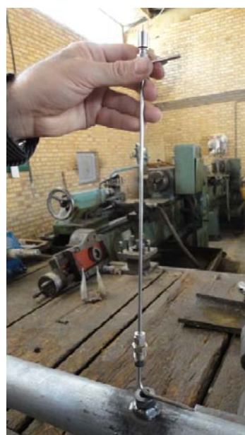
شکل ۲-۲۸: نحوه‌ی قرار گیری پیتوت درون لوله
