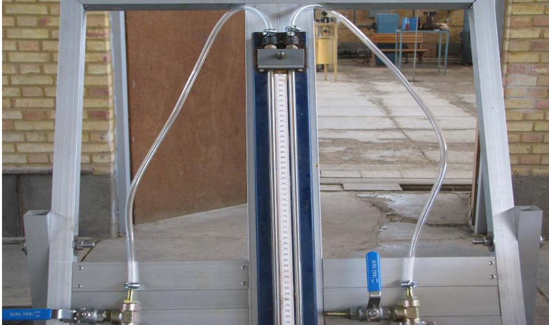
شکل ۴۳-۲: نحوه‌ی اتصال مانومتر به شیرها
