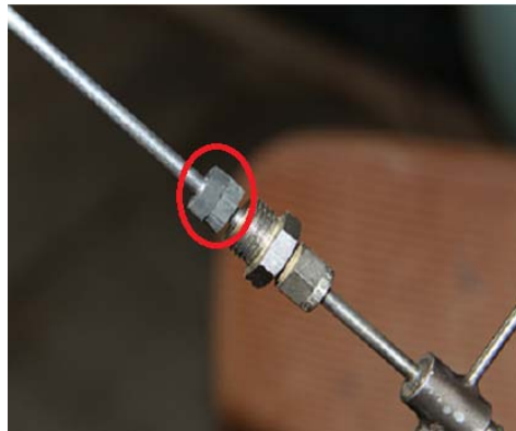
شکل ۲-۳۰: استفاده از آب‌بند لاستیکی برای سیل کردن پیتوت
