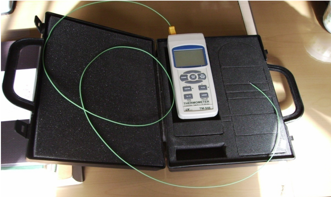
شکل ۲-۵۹: ترمومتر استفاده شده برای اندازه‌گیری دمای جریان گاز خروجی
