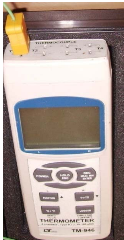
شکل ۲-۶۰: محل نصب سنسور دما در ترمومتر
