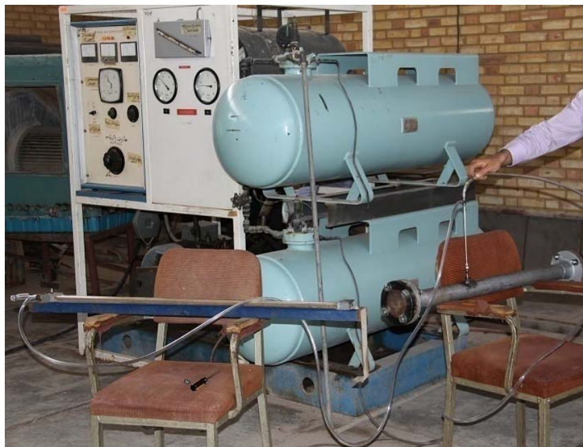
شکل ۲-۳۴: نمای کلی از تست نشتی دبی‌سنج
