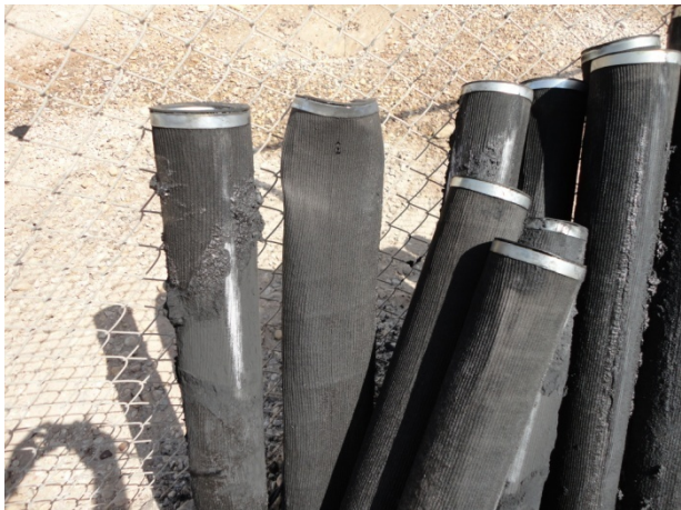
شکل ۲-۴: فیلترهای معیوب شده در عرض کمتر از یک هفته
