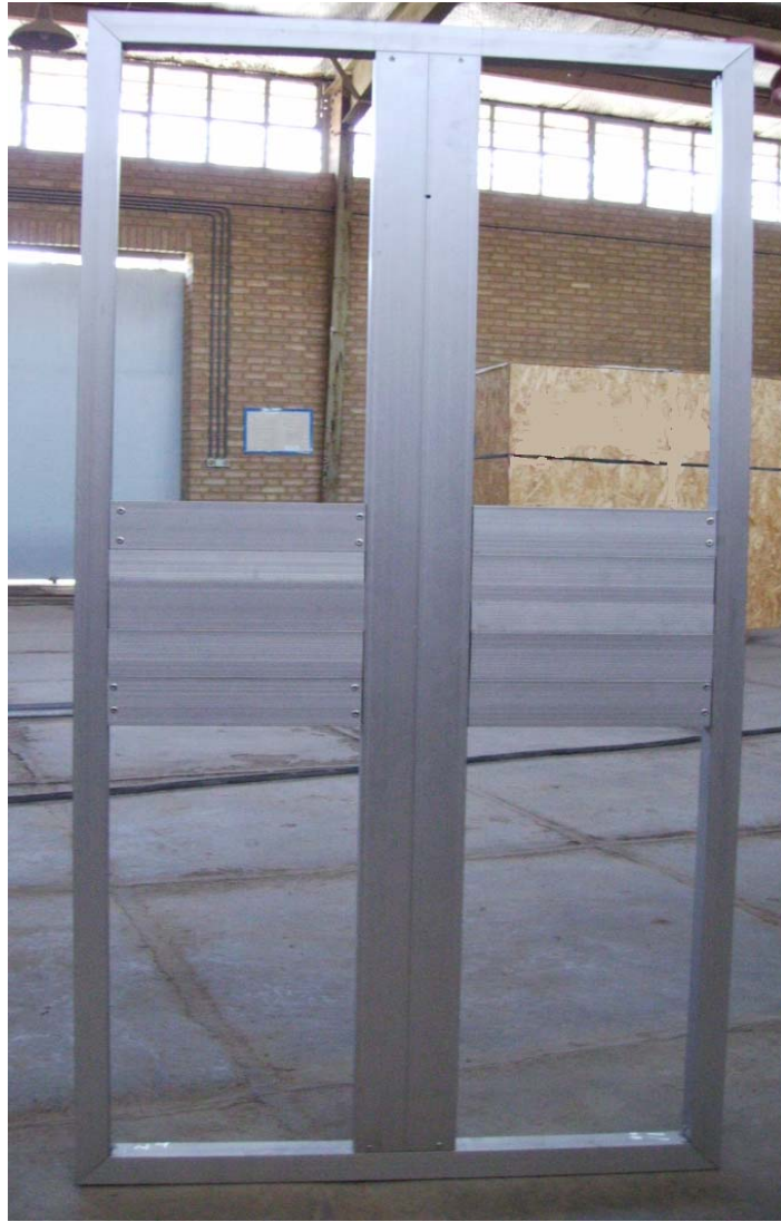
شکل ۲-۳۷: بورد جهت نصب مانومتر
