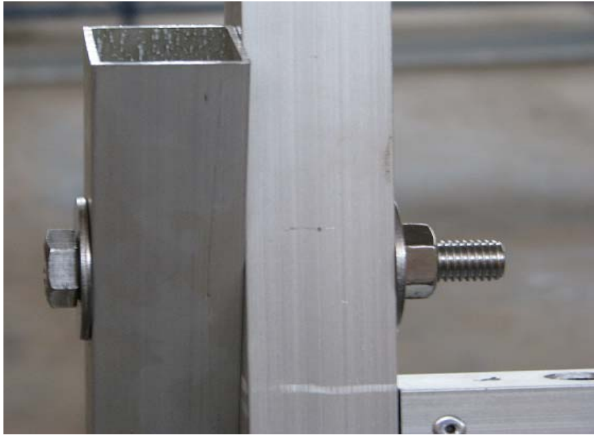
شکل ۲-۴۱: نحوه‌ی اتصال بورد مانومتر به پایه
