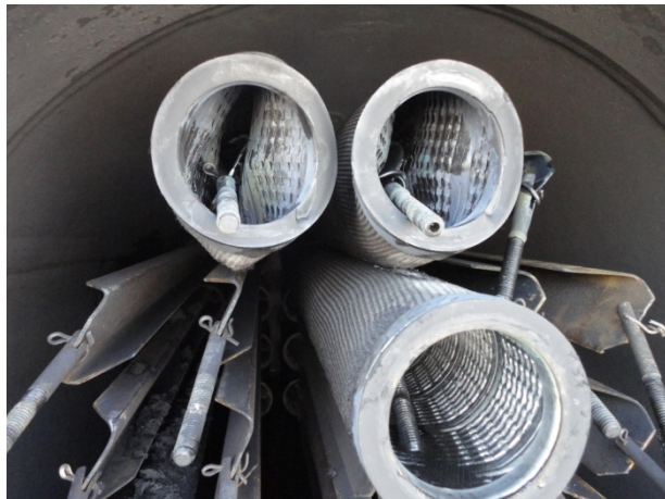
شکل ۲-۴: فیلترهای معیوب شده در عرض کمتر از یک هفته
