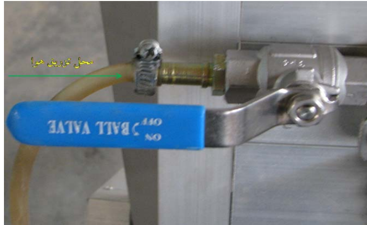
شکل ۲-۴۶: تزریق هوا به دبی سنج
