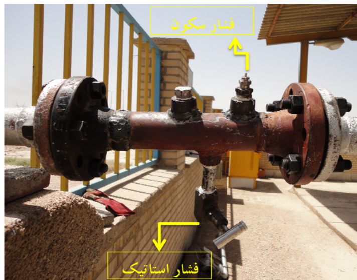
شکل ۲-۸: دبی‌سنج طراحی شده بر مبنای لوله پیتوت
